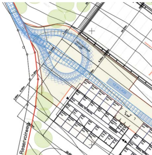
Zu- und Wegfahrt vom Reservoirweg
