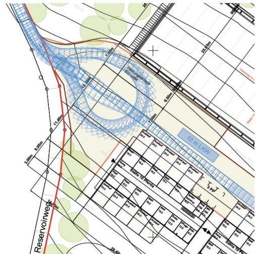
Zu- und Wegfahrt vom Reservoirweg
