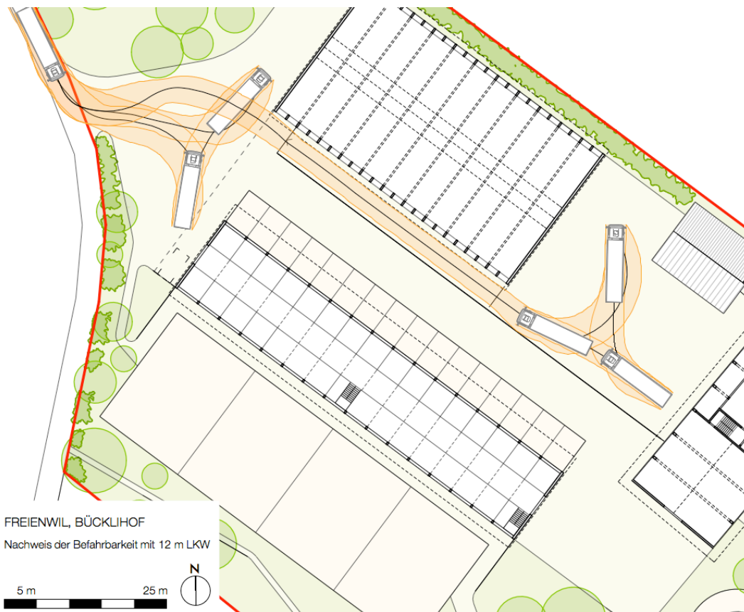
Abbildung 5: Nachweis Befahrbarkeit mit 12 m Lastwagen (Stand Richtprojekt März 2017)
