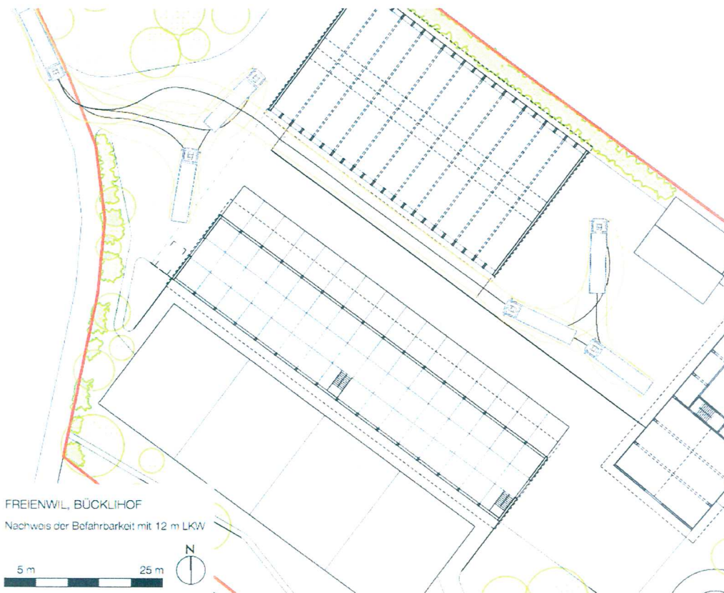
Abbildung 8: Nachweis Befahrbarkeit mit 12 m Lastwagen (Stand Richtprojekt März 2017)
